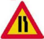
(Κ-6β) Επικίνδυνη στένωση οδοστρώματος στην δεξιά πλευρά.
